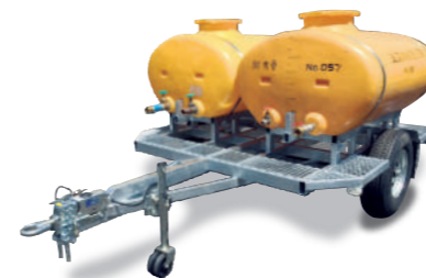
消防用水タンクトレーラー
